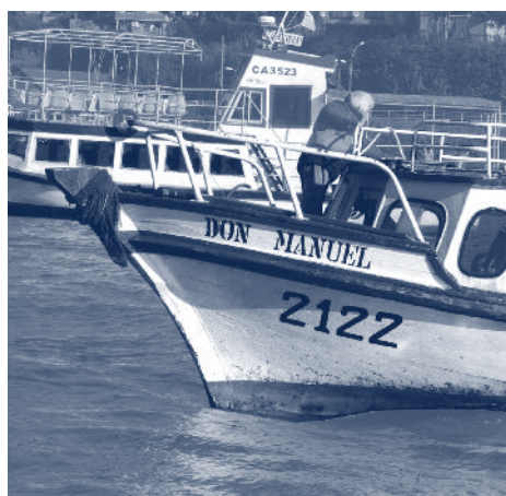
Figura 5: Curvatura cóncava de la roda, sello distintivo de la familia Villanueva. Fuente: Elaboración propia.
